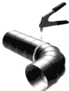
Прикрепить фасонную часть к трубе заклепками (саморезами)
